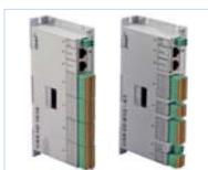
CAN I-O modules
